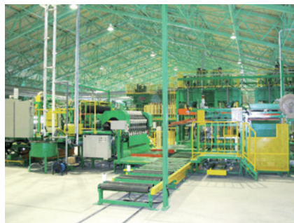
3'x6'~メーターサイズ セミレイアップ装置 Полуавтоматическое оборудование для укладки листов шпона в пакеты форматами 3'x6' - 1mx2m
