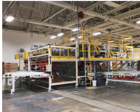
4'x8' ベニヤセッター (仕組機) Стопокладчик шпона форматом 4'x8'
