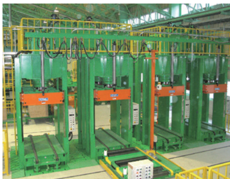
3'x6'~メーターサイズ 450トン コールドプレス Холодный пресс усилием 450 т. для фанеры форматами 3'x6' - 1mx2m
