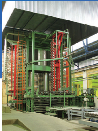
5'x10' 30段 950トン ホットプレス 30-этажный горячий пресс усилием 950 т. для фанеры форматом 5'x10'
