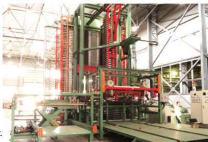
5'x5' 20段 500トン ホットプレス-ダイレクトシステム 20-этажный горячий пресс усилием 500 т. для фанеры форматом 5'x5' и прямой вставкой пакета листов шпона
