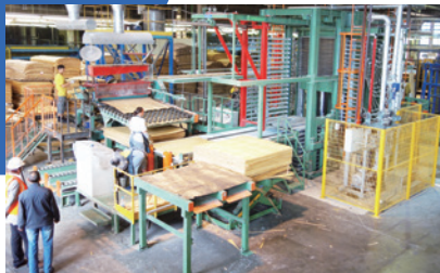
5'x5' 20段 500トン ホットプレス-ダイレクトシステム 20-этажный горячий пресс усилием 500 т. для фанеры форматом 5'x5' и прямой вставкой пакета листов шпона
