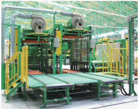
3'x6'~メーターサイズ ベニヤセッター (仕組機) Стопокладчик шпона форматами 3'x6' - 1mx2m
