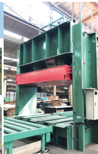
5'x10' 750トン コールドプレス Холодный пресс усилием 750 т. для фанеры форматом 5'x10'
