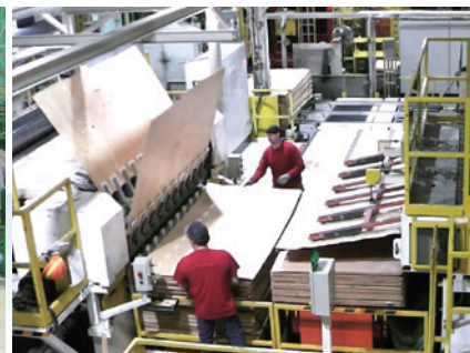
4'x8' セミレイアップ装置 Полуавтоматическое оборудование для укладки листов шпона в пакеты форматом 4'x8'
